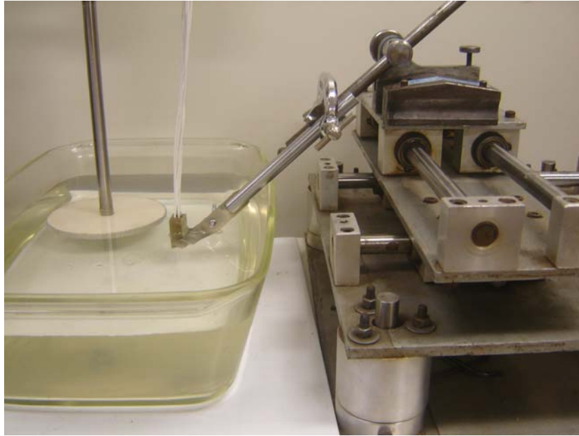
Figura V.7. Vista lateral do posicionamento do transdutor.
