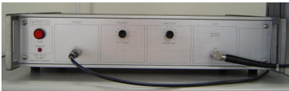
Figura IV.3 – Imagem do gerador de pulsos monociclo utilizado para excitar o transdutor.
