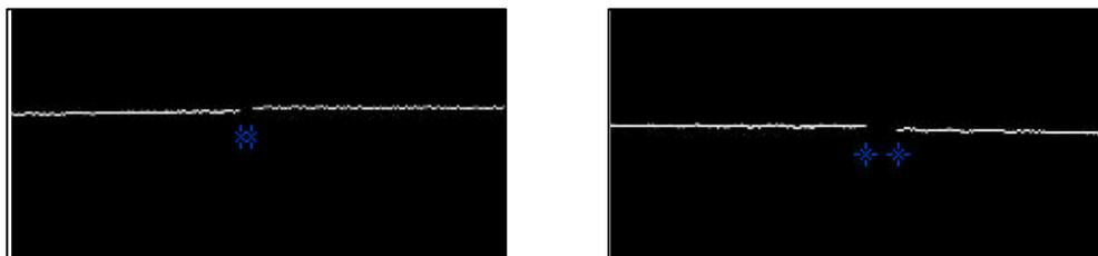
Figura V.11 – *Phantom* formado por duas lâminas de aço com uma ranhura central de: a) 80  $\mu\text{m}$  e b) 200  $\mu\text{m}$ , para medição de  $R_{lat}$ .
