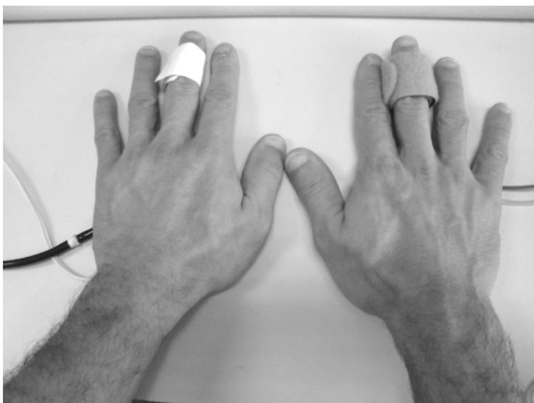
Figura VI.6.2: Os dois *cuffs* posicionados: à esquerda o *cuff* construído para o sistema e à direita o do Portapres
