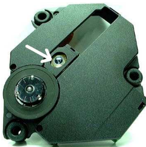
Figura III.3: Lente utilizada em leitores de CD.
