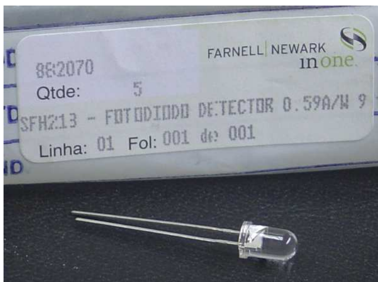
Figura III.14: Fotodiodo para detecção do espalhamento direto.
