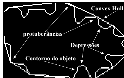
Figura V.3. Exemplo de objeto (contorno com protuberâncias e depressões) e seu respectivo polígono convexo (menor contorno convexo).
