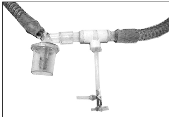
Figura 7 – Fotografia da montagem do adaptador para coleta dos gases expirados e suas conexões: o ramo expiratório e o coletor de umidade.
