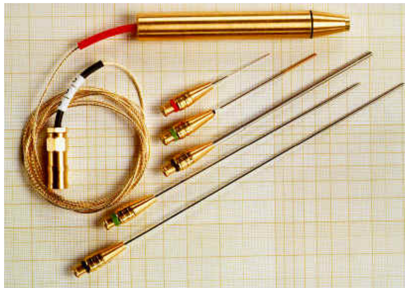
FIGURA 60. Alguns hidrofones tipo agulha disponíveis [67].
