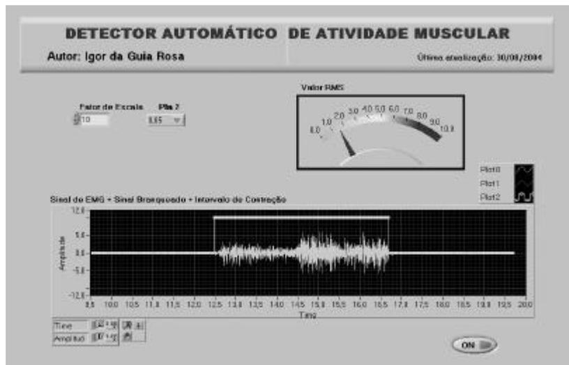
Figura VI.3 – Painel frontal do detector automático de contração muscular
